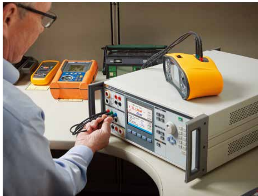
Jeder 5322A wird mit einem externen R-Multiplikator zum Ausgeben von Widerständen von bis zu 10 TΩ zum Prüfen von Isolationsmessgeräten geliefert.
